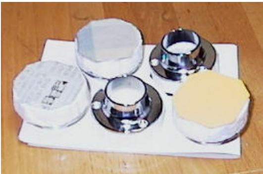
写真 10 断熱性測定用に発泡スチロールを挟んで材料を固定した金具
