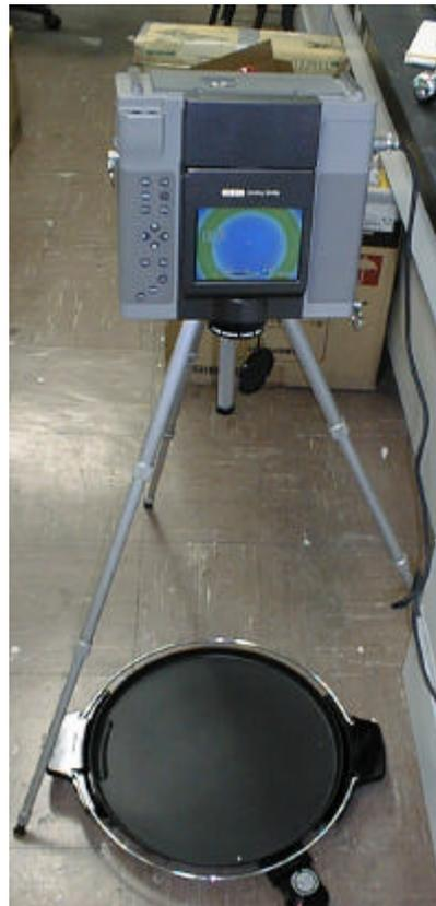
写真 11 ホットプレートのスイッチを入れた直後の赤外線カメラの画像
