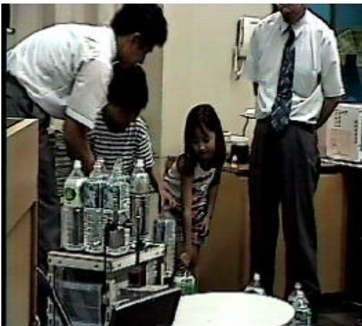
写真 6 新聞紙を膨潤させると 12kg のペットボトルを持ち上げる力が出ます
