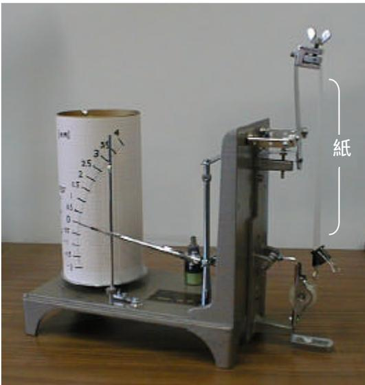
写真 9 毛髪湿度計を改造した紙の伸縮測定装置
