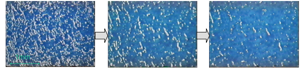
A2塗工紙に印刷したときのスプリットパターン消失過程
