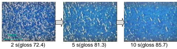
A2塗工紙に印刷したときのスプリットパターン消失過程
