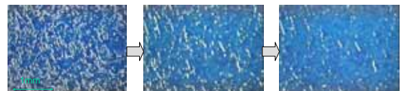
A2塗工紙に印刷したときのスプリットパターン消失過程
