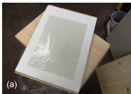
図 2-7 水処理実験手順(ろ紙の上に置き(a)、積層させて(b)板に挟む(c)
