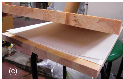
図 2-7 水処理実験手順(ろ紙の上に置き(a)、積層させて(b)板に挟む(c)
